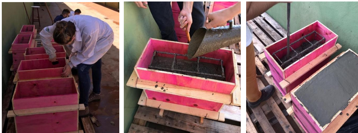
Figura 8 – Moldagem das vigas Fonte: Próprio Autor (2019).
